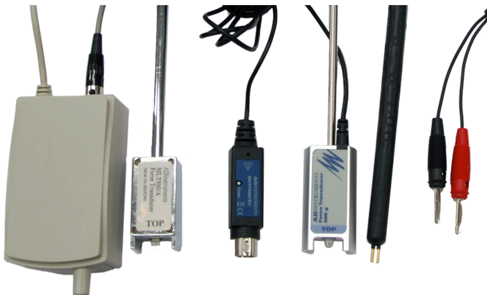
図18-1. トランスデューサと刺激電極。左から旧タイプ張力トランスデューサ用ブリッジ・ポッド(前面のつまみを回してゼロ調節を行う)、旧タイプ張力トランスデューサ、新タイプ張力トランスデューサ・アダプタ、新タイプトランスデューサ、刺激電極兼標本固定棒(以下刺激極電極棒、先端の2本の金色部分が電極でここに座骨神経を置く)、同左のバナナコネクタ。
