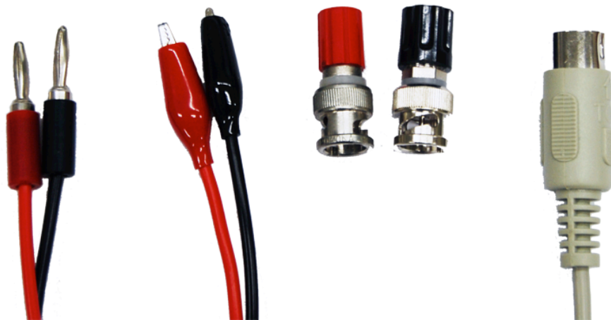
図17-1. コネクタの名称。左からバナナコネクタ、ミノムシクリップ、BNC-バナナ変換アダプタ、DIN8P コネクタ
